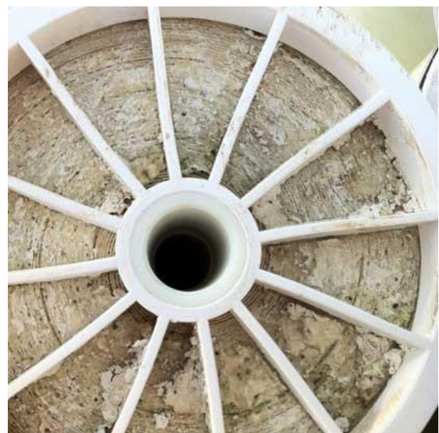
Abbildung 13: Kalk auf der Membrane einer Umkehrosmoseanlage
