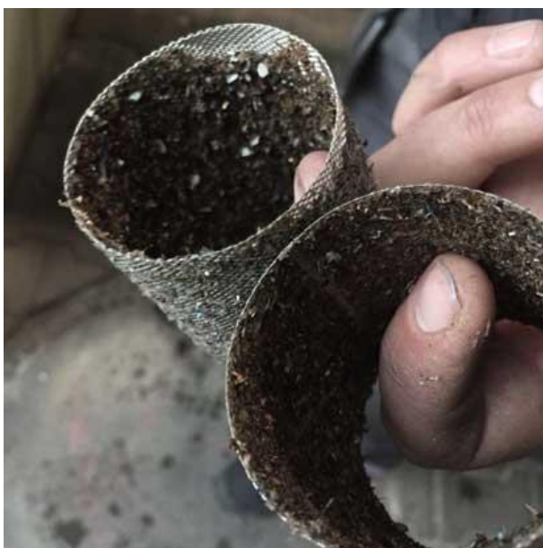
Abbildung 12: Ungereinigte dreckige Filtersiebe
