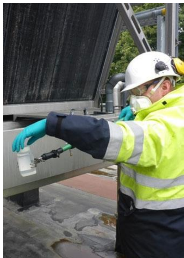
Abbildung 32: Mitarbeiter der aqua-Technik Beratungs GmbH entnimmt Kühlwasserprobe
