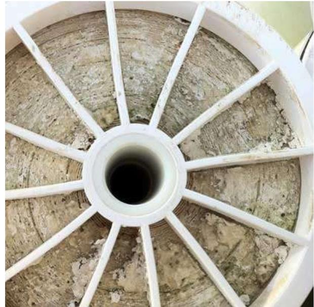
Abbildung 13: Kalk auf der Membrane einer Umkehrosmoseanlage
