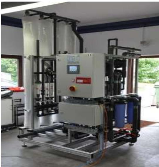
Abbildung 18: UO Anlage 8 m<sup>3</sup>/h mit EH Ventilautomatik
