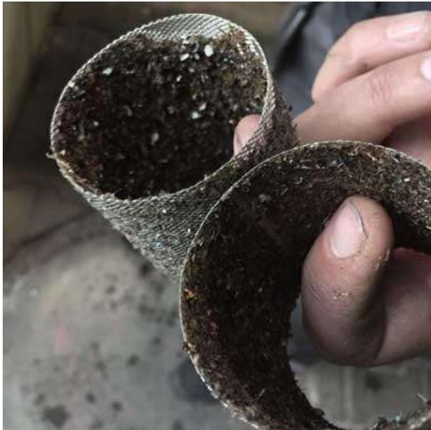
Abbildung 12: Ungereinigte dreckige Filtersiebe
