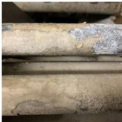
Abbildung 8: Kalkablagerungen am Rohrbündelwärmetauscher eines Kühlturms
