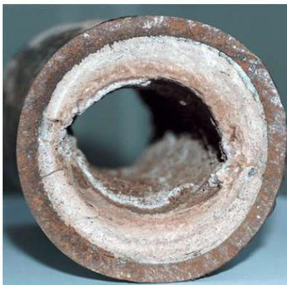
Abbildung 7: Rohrstück, das sehr viele Kalkablagerungen aufweist durch Kalk im Kühlwasser
